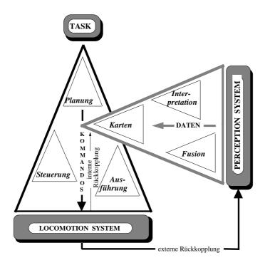
Der die Kommandos generierende Ast der DV benutzt die "Karten" für Module "Planung", "Steuerung" und "Ausführung", die über Kommandos und Rückmeldungen miteinander kommunizieren. Von außen wird dem System eine Reihe von Tasks vorgegeben und über die Umwelt geschieht eine Rückkopplung zwischen dem Bewegungsapparat und der Sensorik des AMR.
