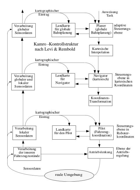
Eine DV-Schicht verarbeitet lokal einen Teil der Sensordaten und reicht den anderen Teil in die nächst höhere Schicht weiter. Sie erzeugt eine schichtspezifische Repräsentation der Umwelt und leitet daraus die Steuerbefehle dieser Schicht ab. Ein Teil der Aufgabe wird dabei an die nächst tiefere Schicht delegiert. Jede Schicht erzeugt Rückmeldungen an die nächst höhere Schicht.
