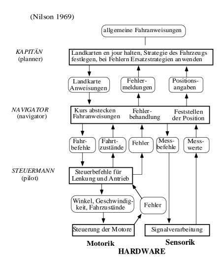
Diese Art von Kontrollstruktur ist zunächst naheliegend und beschreibt eine natürliche Aufgabenteilung in der Datenverarbeitung eines AMR. Sie hat allerdings den Nachteil, dass der AMR nur dann korrekt arbeitet, wenn alle Teile funktionieren.
